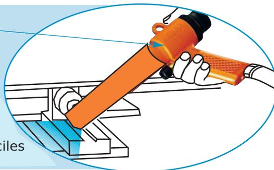
**METALURGIA:** La pistola de aire comprimido reversible con herramienta accesoria de grietas facilita el trabajo de aspirado y refrigeración de virutas metálicas en áreas difíciles
