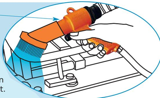
**IMPRESA:** La pistola de aire comprimido reversible mejora la calidad del producto y el ambiente de trabajo en la imprenta limpiando eficientemente del polvo de la offset.
