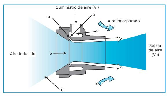
Vi= Volumen de aire suministrado (aire libre a presión atmosférica) Vo= Volumen de salida, canalizado = Vi + aire inducido Vo= Volumen de salida, no canalizado = Vi + aire inducido + aire arrastrado
